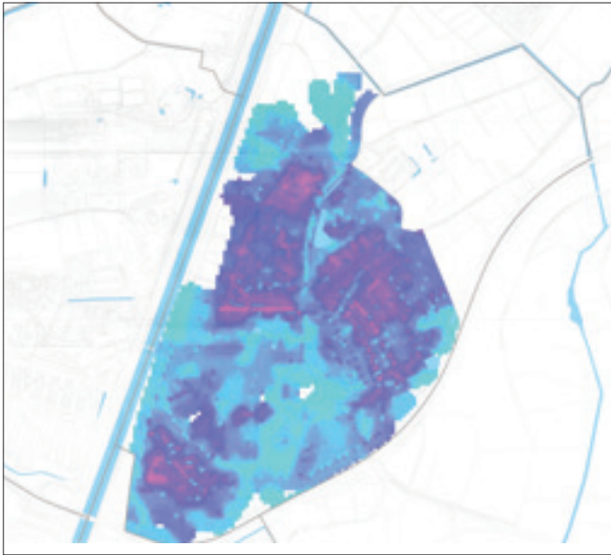
▲ De heat map . Buurten waar voor vrijwel alle beheerdisciplines een opgave ligt, kleuren rood. Het plangebied 'Molenweg en Omgeving' is rechtsboven zichtbaar. De twee andere gebieden die rood kleuren, zijn in de voorgaande jaren gerehabiliteerd.
